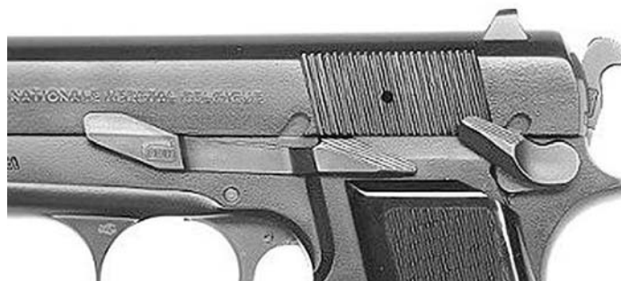
Особени знаци модела са механизмом за окидање SFS – редуцирани задржач навлаке и скраћена мамуза ударача
